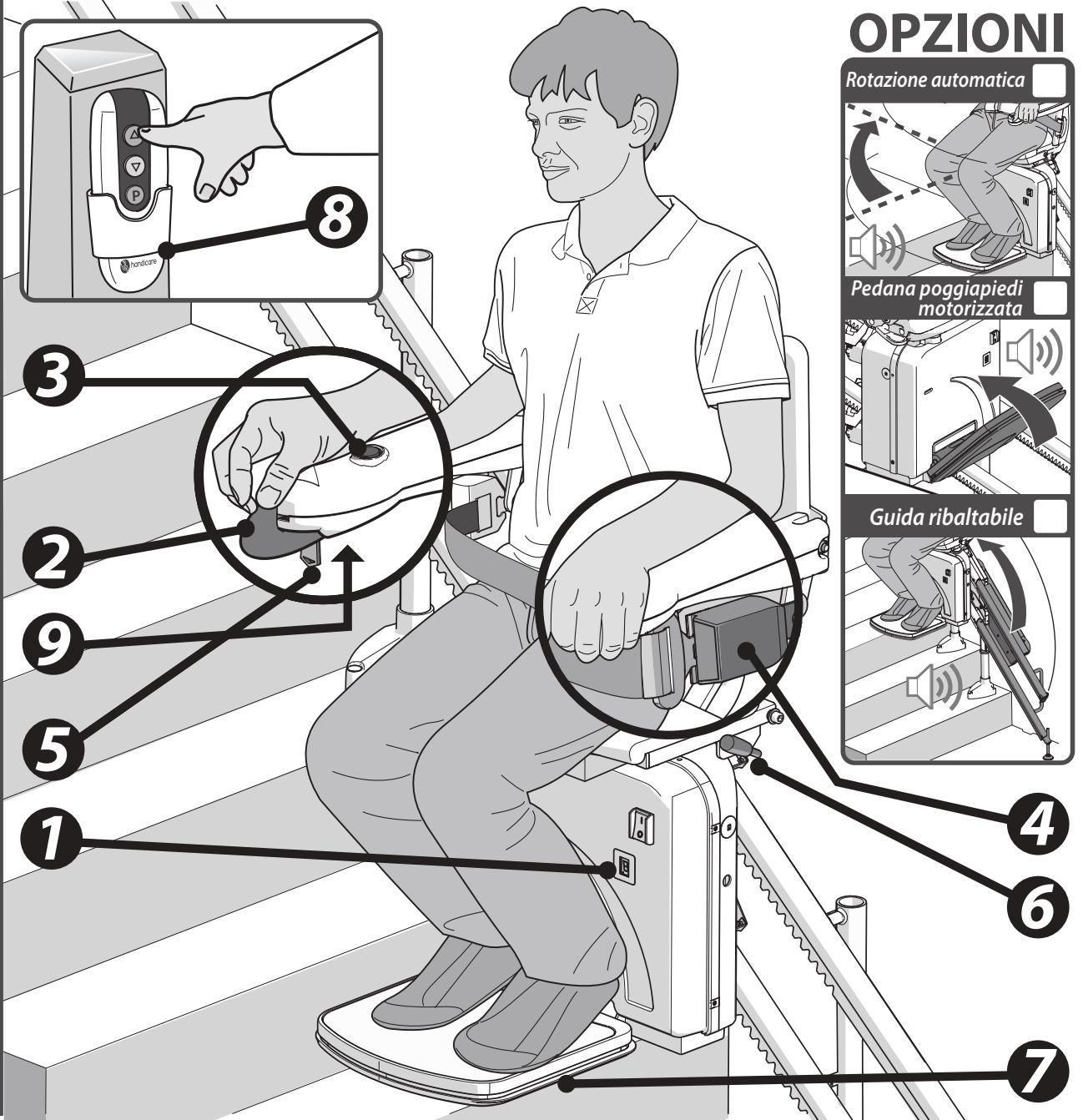
L'illustrazione qui riportata mostra i componenti attraverso i quali l'utente può controllare il sedile STYLE. Per aumentare la comodità e la facilità di utilizzo, è possibile dotare il modello STYLE dei seguenti optional: sedile girevole automatico, pedana poggiapiedi automatica e il guida ribaltabile.
