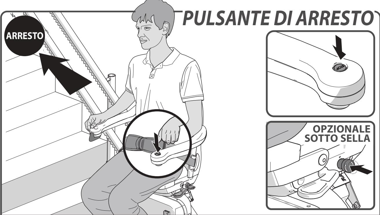
In caso di emergenza, premere il pulsante di Stop una volta. Il pulsante di Stop si accende. Il montascale si ferma immediatamente.
