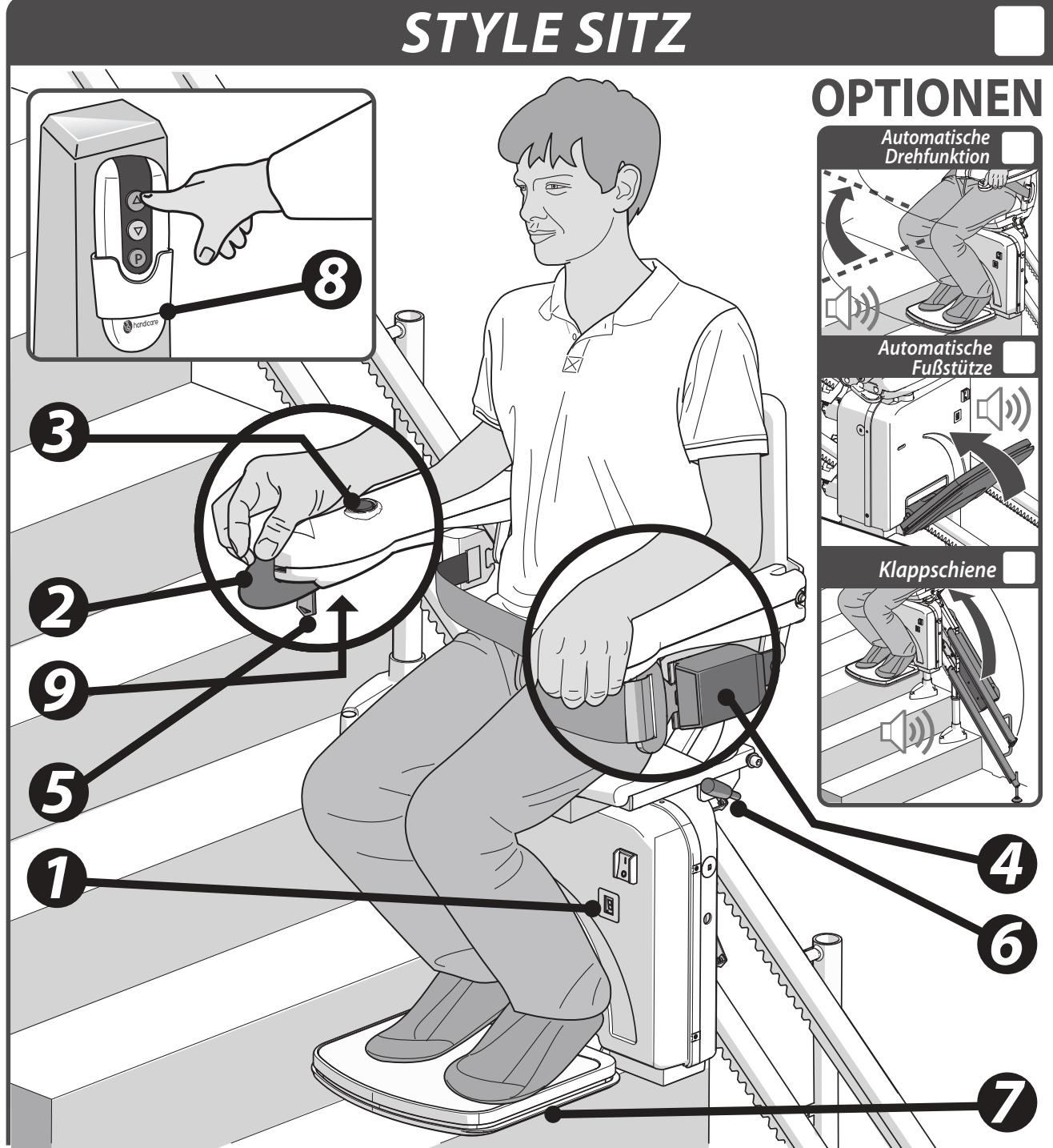
Die nebenstehende Illustration zeigt die Elemente, mit denen Sie den STYLE Sitz bedienen. Um den Sitzkomfort und die Bedienungsfreundlichkeit zu erhöhen, können Sie den STYLE Sitz um folgende Optionen erweitern: automatischer Drehsitz, automatische Fußstütze und der Klappschiene.
