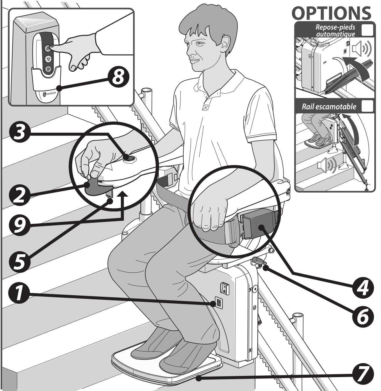
L'illustration ci-dessus montre les éléments à l'aide desquels vous pouvez commander le siège SIMPLICITY. Afin d'améliorer le confort d'assise et la facilité d'utilisation, vous pouvez équiper le siège SIMPLICITY des options suivantes: siège pivotant automatique, repose-pieds automatique et le rail escamotable.
