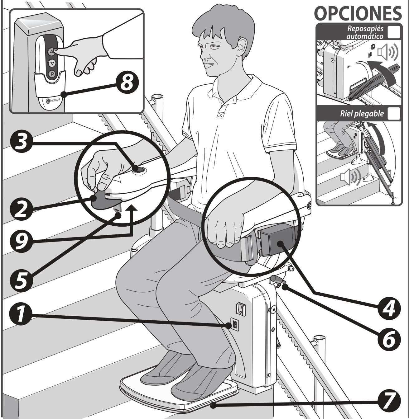
En el dibujo al lado se muestran los componentes de control de la silla SIMPLICITY . Para aumentar el confort y la facilidad de uso, puede ampliar la silla SIMPLICITY con las siguientes opciones: silla de giro automático, reposapiés automático y el riel plegable.
