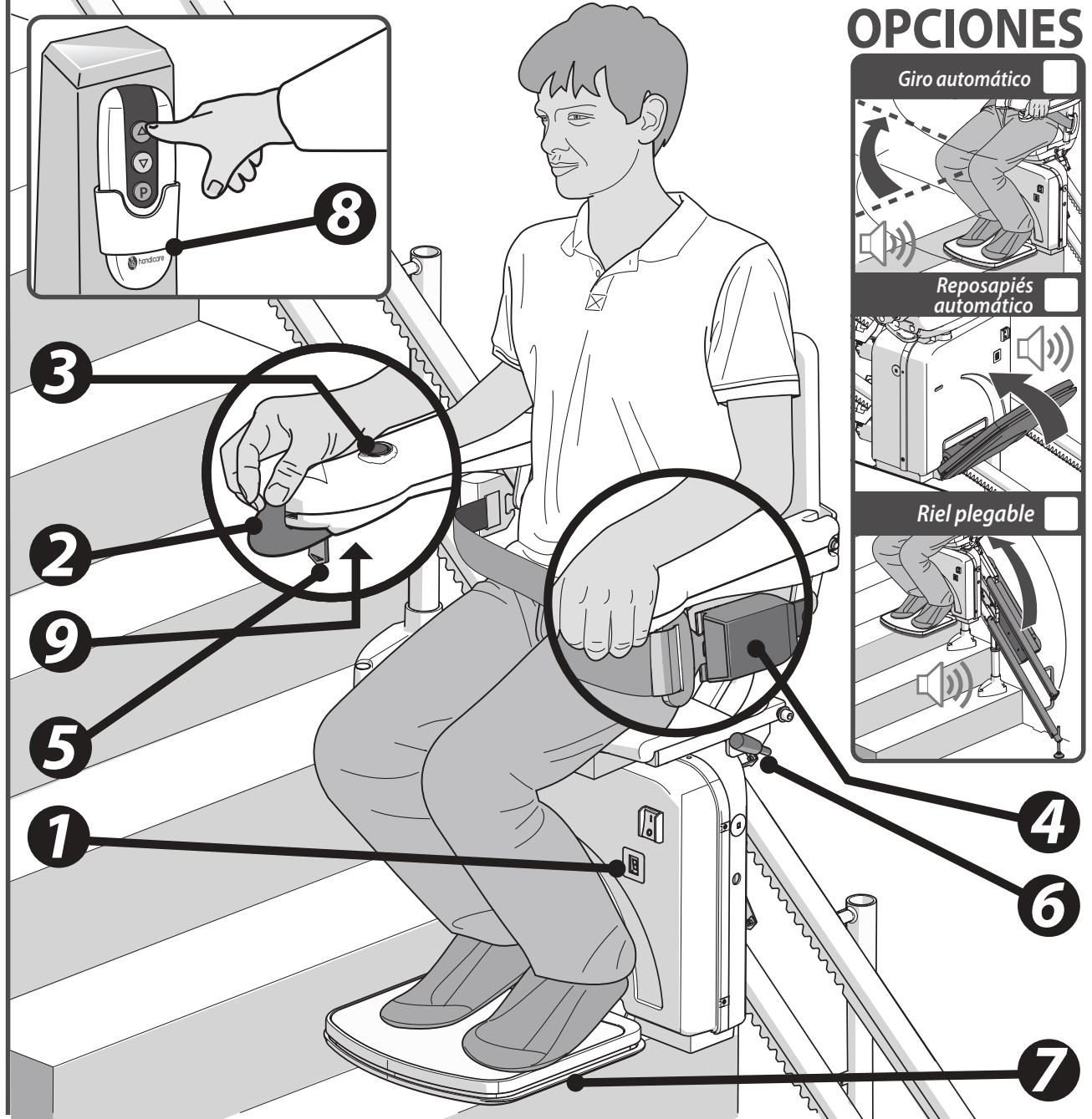
En el dibujo al lado se muestran los componentes de control de la silla STYLE . Para aumentar el confort y la facilidad de uso, puede ampliar la silla STYLE con las siguientes opciones: silla de giro automático, reposapiés automático y el riel plegable.
