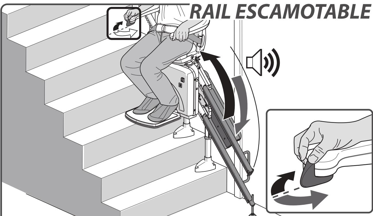
Avec l'option de RAIL ESCAMOTABLE, le siège s'arrête lorsqu'il se trouve juste au-dessus du rail escamotable. Actionnez la manette vers le haut ou vers le bas afin de replier ou de déplier le rail (uniquement sur configuration Siège standard).
