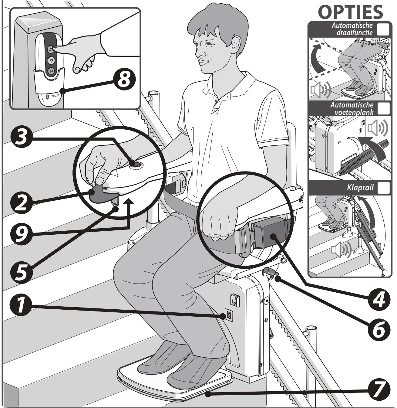
De illustratie hiernaast toont de onderdelen waarmee u de STYLE stoel bedient. Om het zitcomfort en gebruiksgemak te vergroten, kunt u de STYLE stoel uitbreiden met de opties: automatische draaistoel, automatische voetenplank en de klaprail.
