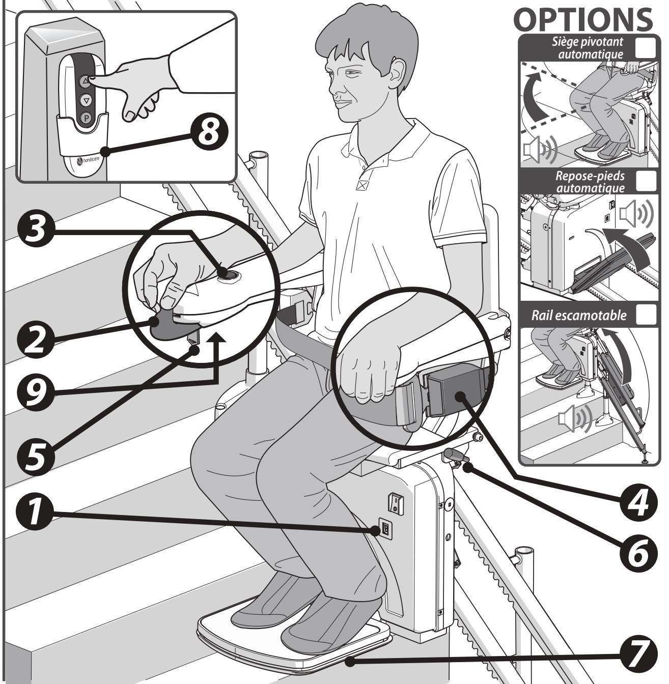
L'illustration ci-dessus montre les éléments à l'aide desquels vous pouvez commander le siège STYLE. Afin d'améliorer le confort d'assise et la facilité d'utilisation, vous pouvez équiper le siège STYLE des options suivantes: siège pivotant automatique, repose-pieds automatique et le rail escamotable.
